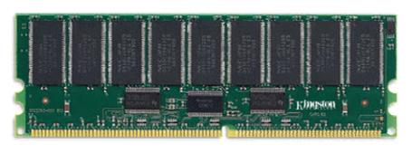
**2. DIMM 184 pin**. Применяются DDR SDRAM, памятью соответственно тоже назывались DIMM DDR SDRAM. В отличии от DIMM 168 pin, такие модули имеют всего 1 ключ, защищающий их от неправильной установки(см. рисунок). модули памяти настоящее
