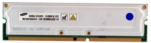
**RIMM** 232 pin. Применяются с 32-битным вариантом Rambus, также имеют 1 или 2 ключа.
