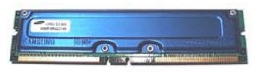
RIMM 184 ріп. Применялись с 16-битным вариантом Rambus, имели 1 или 2 ключа (прорези) в центральной части модуля, положение и количество которых зависело от используемого напряжения
