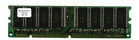
**1. DIMM 168 ріп**. Применялись с памятью SDRAM, поэтому такие модули называли просто DIMM SDRAM. Имели 2 ключа
