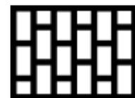
Преимущества щелевой маски: Более насыщенный цвет, нежели при использовании дельтовидной технологии, за счет большей площади светящегося люминофора, однако такая маска несколько проигрывает в четкости наклонных линий.
